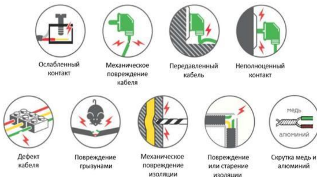
Рисунок 6. Возможные причины искрения в электропроводке
